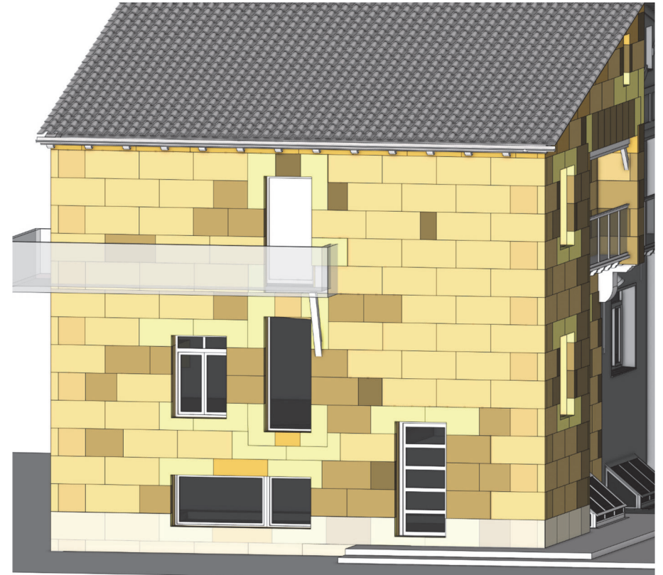
Ilustración 75: Resultado final del planteamiento de placas de aislamiento en la fachada lateral. Fuente: M. Epelde, A. Intxausti.
