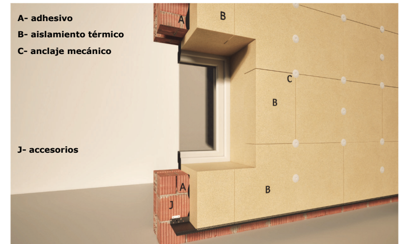
Ilustración 76: Fase de instalación de espigas. Fuente: M. Epelde, A. Intxausti.
