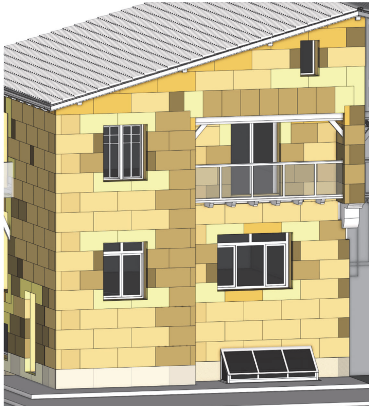
Ilustración 74: Resultado final del planteamiento de placas de aislamiento en la fachada principal. Fuente: M. Epelde, A. Intxausti.
