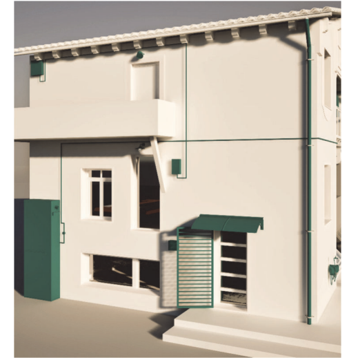
Ilustración 21: Análisis de instalaciones y elementos anclados a fachada que crean discontinuidad en la envolvente térmica (fachada lateral del edificio modelo).
