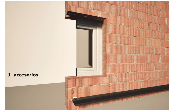
Ilustración 28: Perfil de arranque de instalación previa al aislamiento. Fuente: M. Epelde, A. Intxausti.
