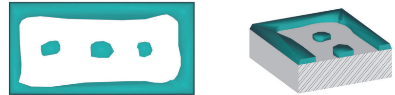
Ilustración 35: Detalle de aplicación del mortero adhesivo para mantener a hueso la junta entre aislantes Fuente: M. Epelde, A. Intxausti.
