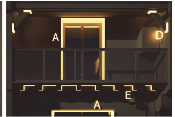
Ilustración 11: Encuentros que impiden la continuidad del aislamiento: fachada con forjado de balcón y solivos (letra E) y huecos (letra A). Fuente: M. Epelde, A. Intxausti.
