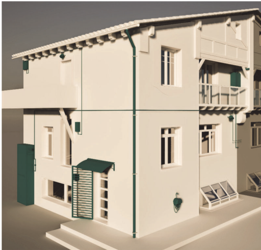
Ilustración 26: Instalaciones a reponer que requieren elementos especiales para pesos en la fase de instalación de aislamiento. Fuente: M. Epelde, A. Intxausti.
