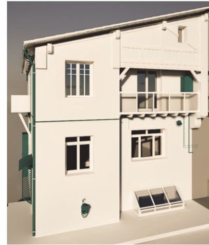
Ilustración 20: Análisis de instalaciones y elementos anclados a fachada que crean discontinuidad en la envolvente térmica (fachada principal del edificio modelo).
