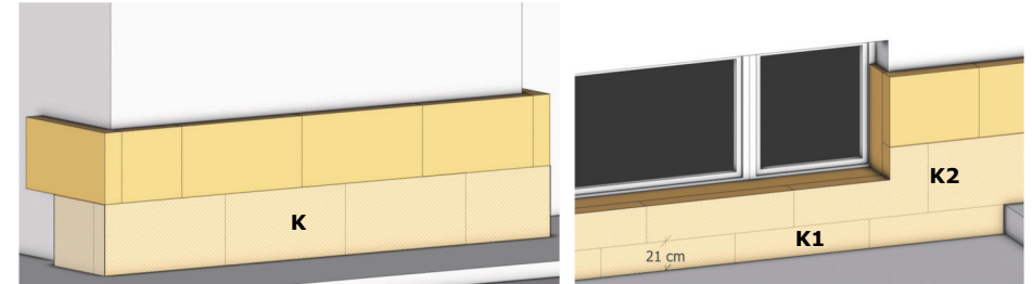
Ilustración 64: Arranque con hilada de aislamiento hidrófugo en fachada principal. Fuente: M. Epelde, A. Intxausti.
