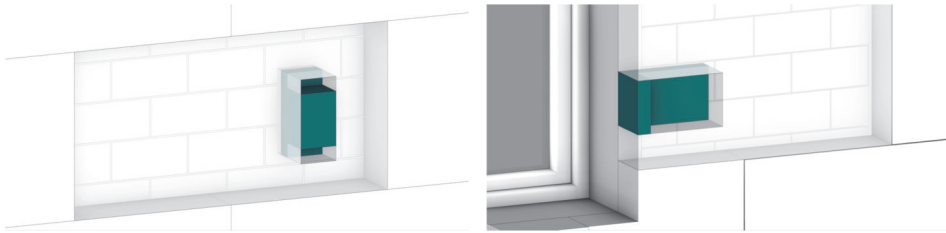
Ilustración 58: Accesorio para la fijación de elementos pesados como marquesinas, toldos y escaleras o para montajes que requieren cálculos estáticos. Fuente: Fuente: M. Epelde, A. Intxausti.
