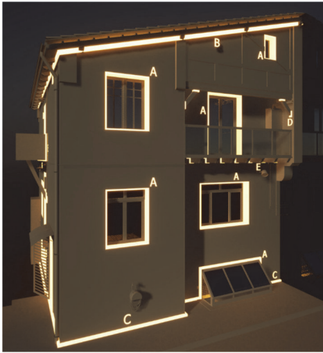
Ilustración 8: Encuentros que impiden la continuidad de la envolvente (fachada principal). Fuente: M. Epelde, A. Intxausti.
