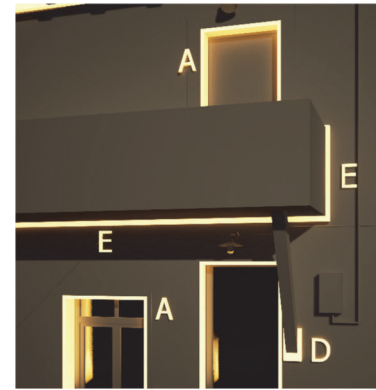
Ilustración 10: Encuentros que impiden la continuidad del aislamiento: fachada con balcón y antepecho (letra E) y fachada con jabalcón (letra D). Fuente: M. Epelde, A. Intxausti.
