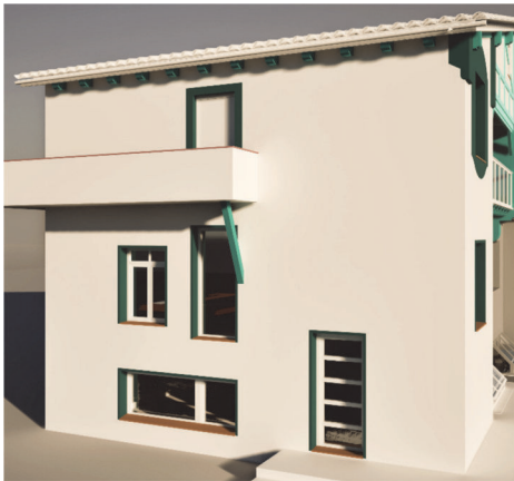
Ilustración 23: Actuaciones en elementos decorativos y alféizares en fachada lateral. Fuente: M. Epelde, A. Intxausti.
