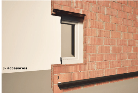
Ilustración 28: Perfil de arranque de instalación previa al aislamiento. Fuente: M. Epelde, A. Intxausti.
