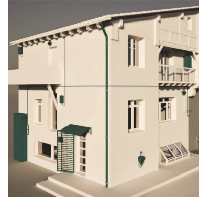
Ilustración 26: Instalaciones existentes en el edificio modelo que requerirán reposición. Fuente: M. Epelde, A. Intxausti.
