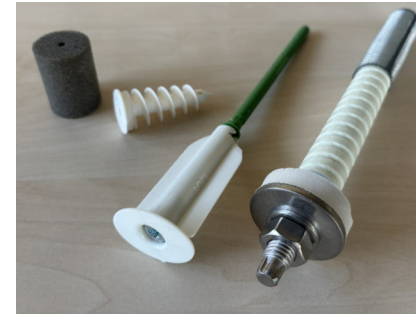
Imagen 31: Tapón para sellado de anclaje de andamio, fijaciones para cargas ligeras (espiral), cargas medias (dardo) y cargas pesadas (barra no metálica). Fuente: Marta Epelde.
