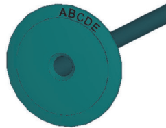
Ilustración 81: Ejemplo de información en la espiga. Fuente: M. Epelde, A. Intxausti.
